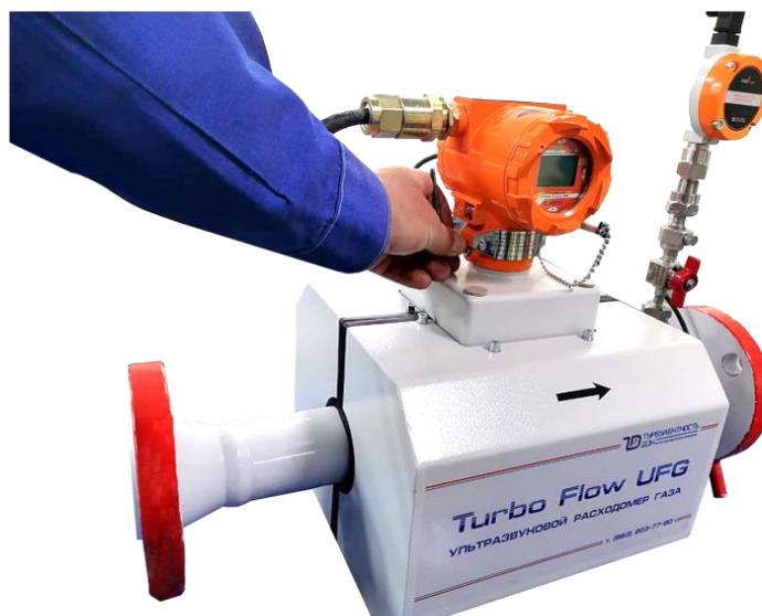
2. Установить ЭБ таким образом, чтобы считывание с индикатора было удобным.
