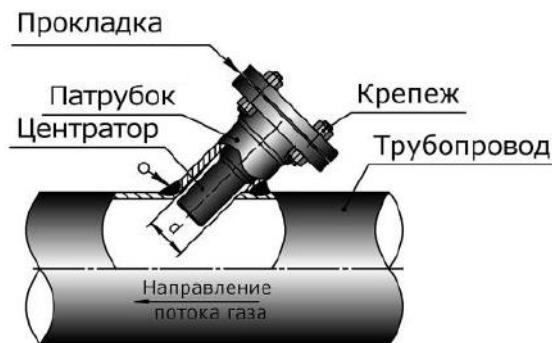
Рисунок 2.18 – Установка центратора в патрубок
