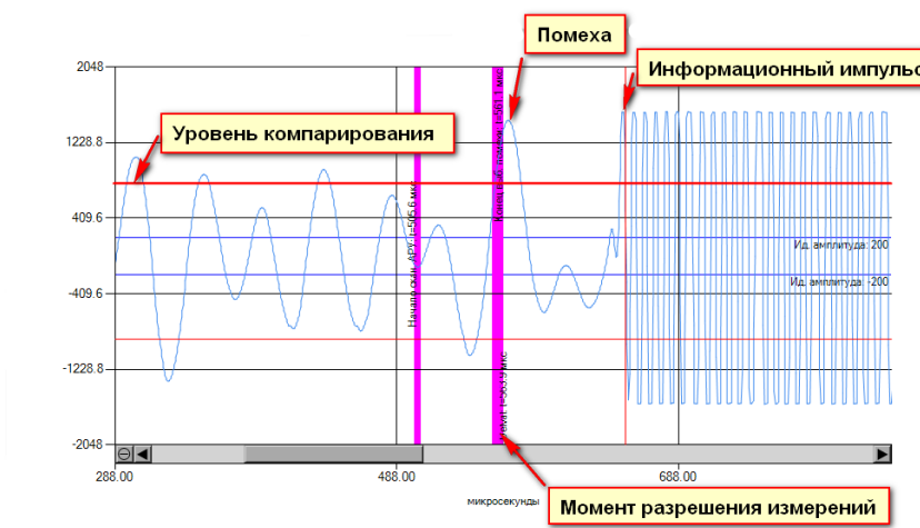
Рисунок 5.1 – Пример сигнала с помехой
