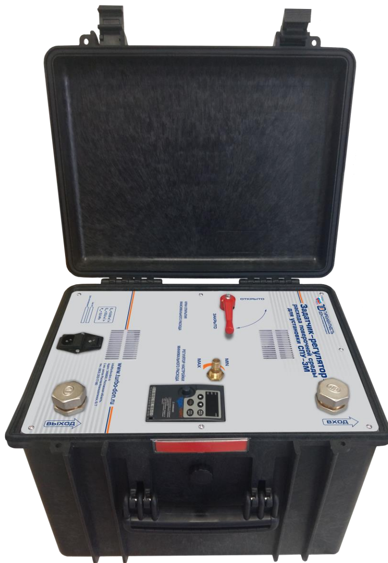
Рисунок А.3 – Задатчик-регулятор расхода для установки СПУ-3М в диапазоне расходов от 0,016 до 25 м 3 /ч
