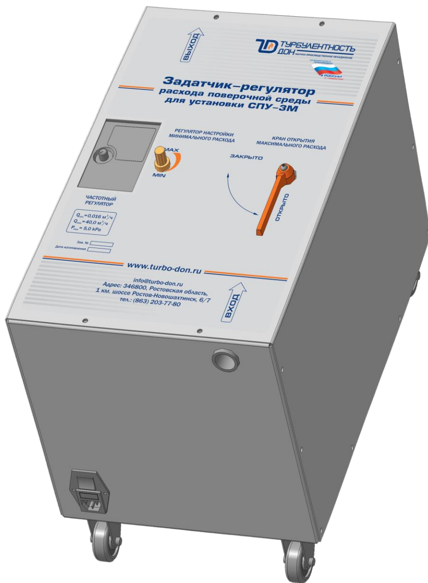
Рисунок А.1 – Задатчик-регулятор расхода для установки СПУ-3М в диапазоне расходов от 0,016 до 40 м 3 /ч.
