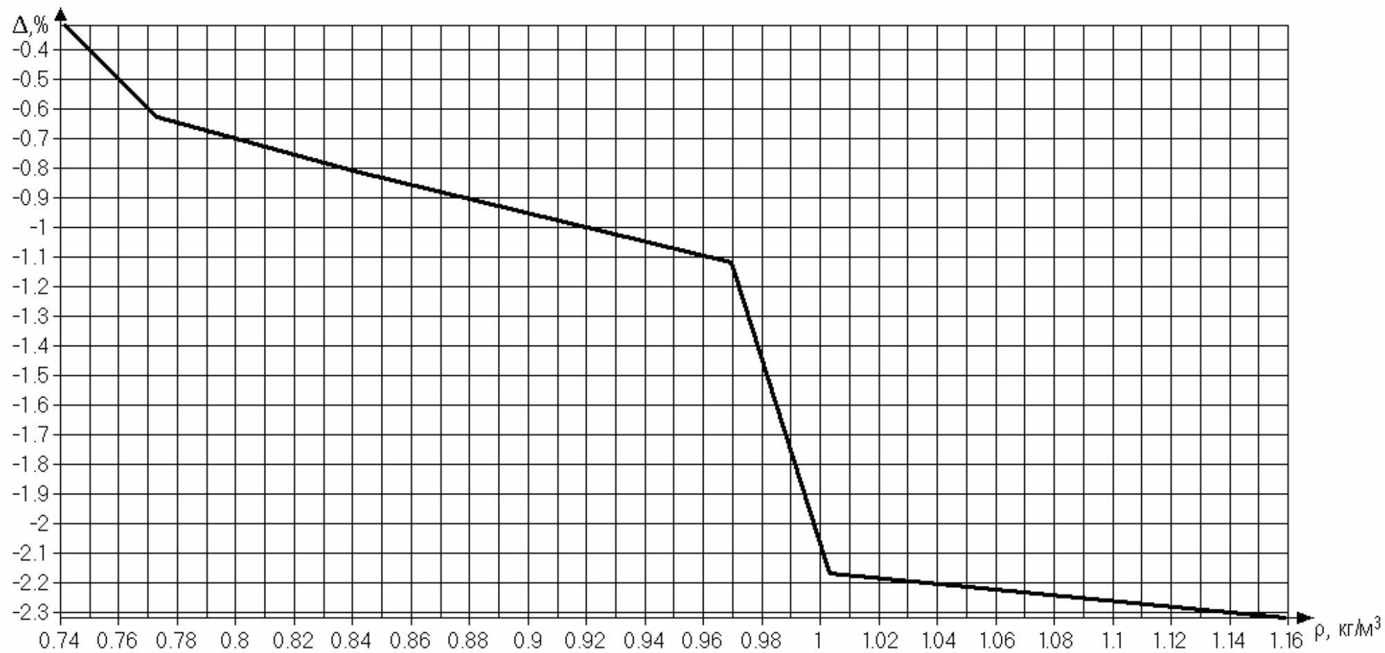
Рисунок 2. Коэффициент K_1 . Зависимость систематической погрешности измерений от плотности газа при стандартных условиях в диапазоне от 0,74 кг/м 3 с содержанием пропана, бутана и высших углеводородов более 2,5% каждого.
