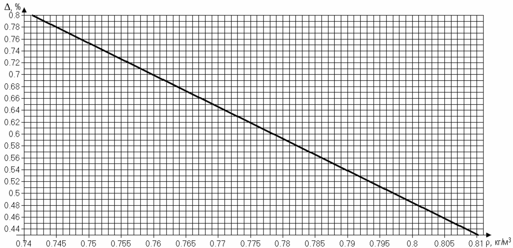
Рисунок 2. Коэффициент K_1 . Зависимость систематической погрешности измерений от плотности газа при стандартных условиях в диапазоне от 0,74 \text{ кг/м}^3 с содержанием пропана, бутана и высших углеводородов не более 2,5% каждого, азота более 5%
