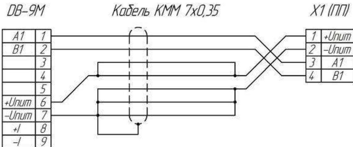
Рисунок М.10 – Схема кабеля при использовании КММ 7×0,35
