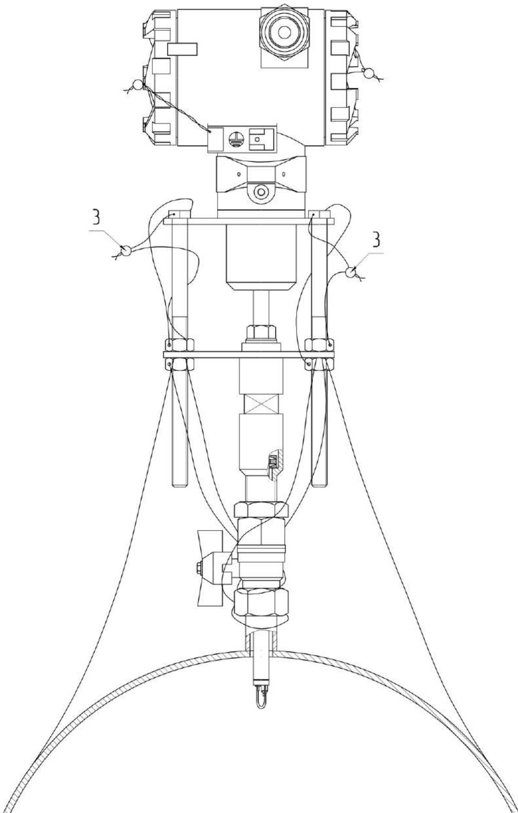
Рисунок Б.5 – Пломбирование блока ПП исполнения Ex db ib при монтаже
