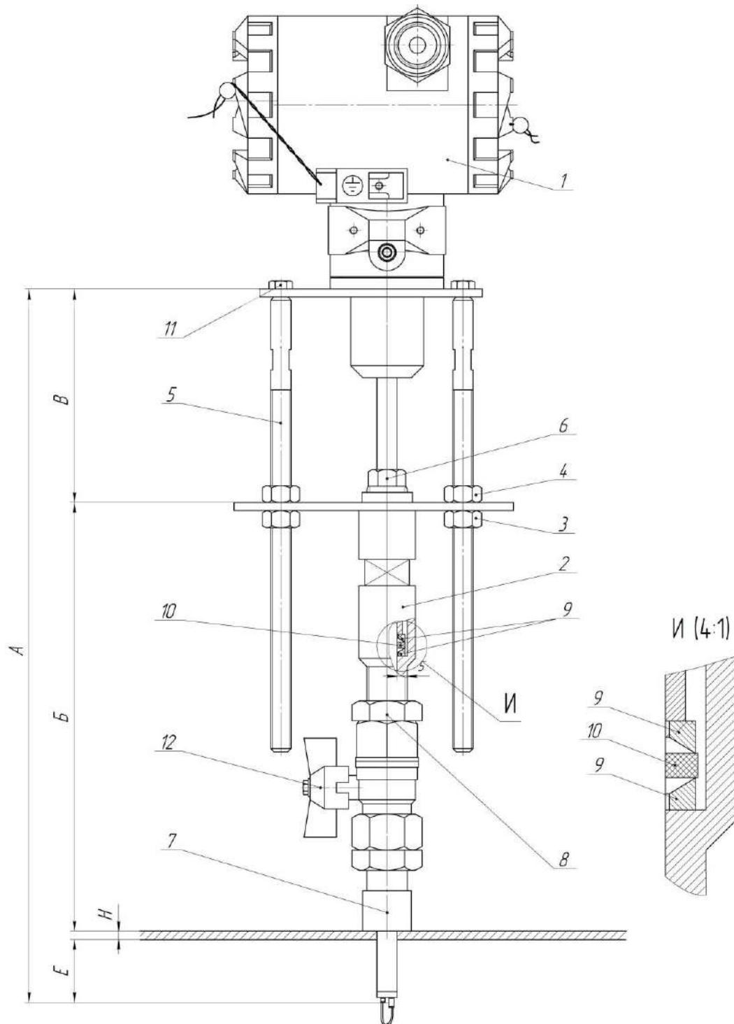
Рисунок Е.2 – Конструкция ввода ПП исполнения Ex db ib
