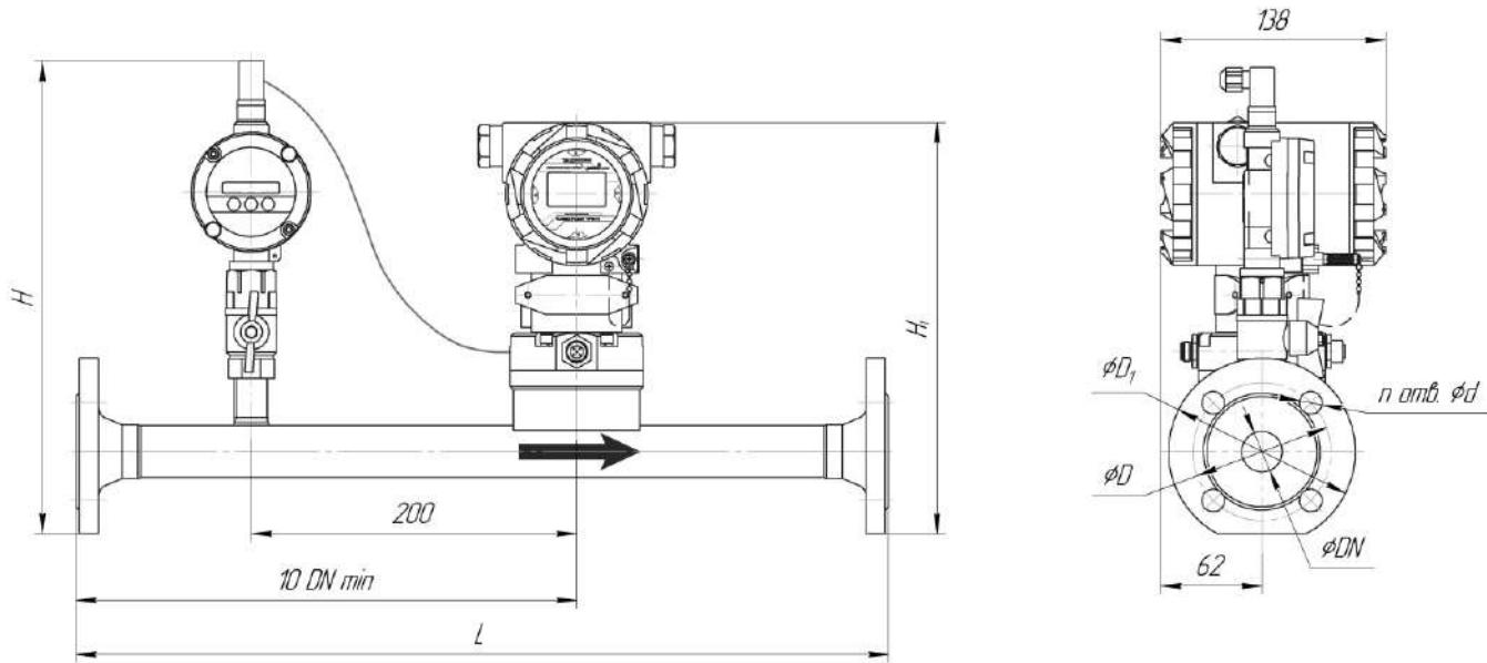
Рисунок Б.6 – Блок ПП с прямым участком предприятия-изготовителя
