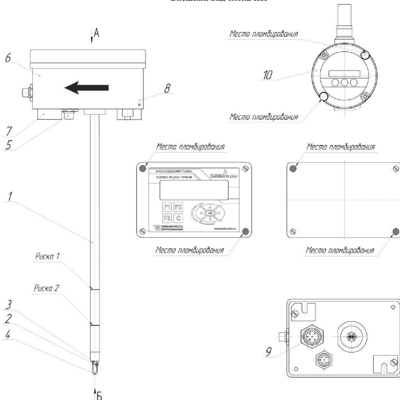
Рисунок Б.1 – Внешний вид блока ПП исполнения Ex ib до 1,6 МПа
