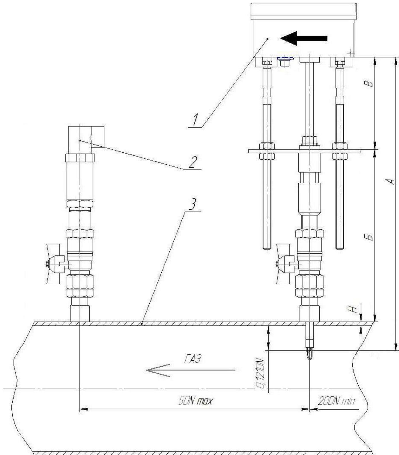
Рисунок Ж.3 – Монтаж ПП на трубопровод
