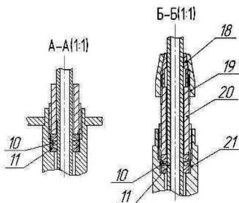
Рисунок К.1 – Монтаж ПП на трубопровод
