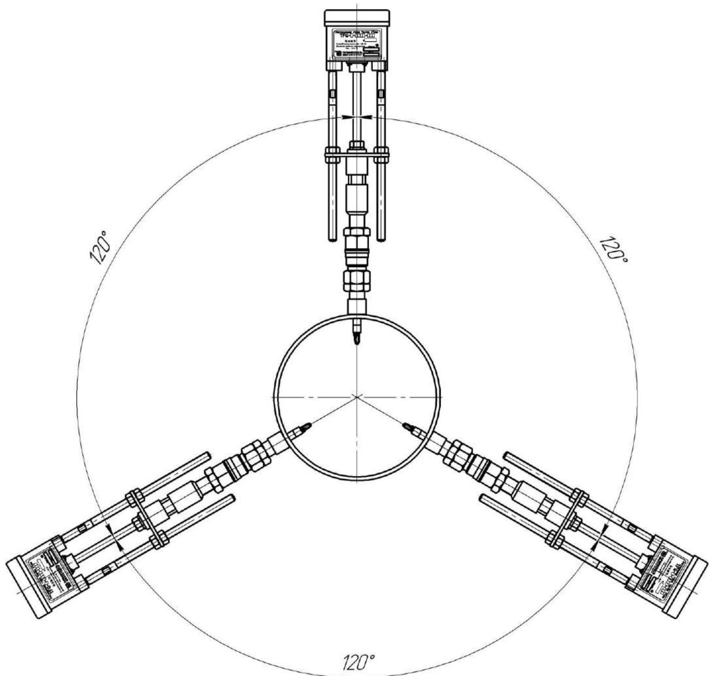
Рисунок Ж.5 – Монтаж трех ПП на трубопровод
