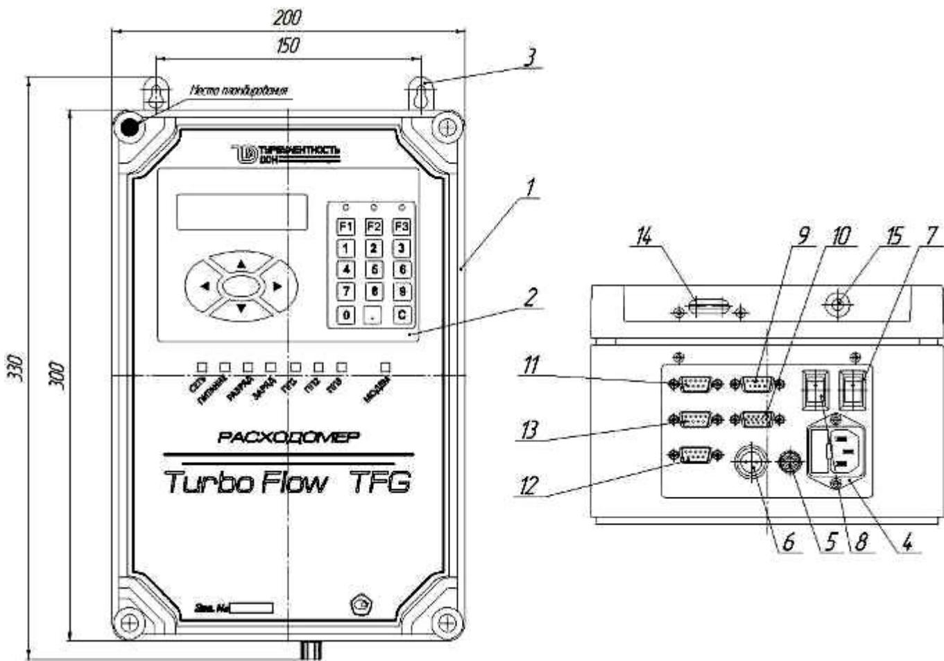
Рисунок В.2 – Внешний вид расходометрного шкафа (стационарное исполнение с тремя ПП)
