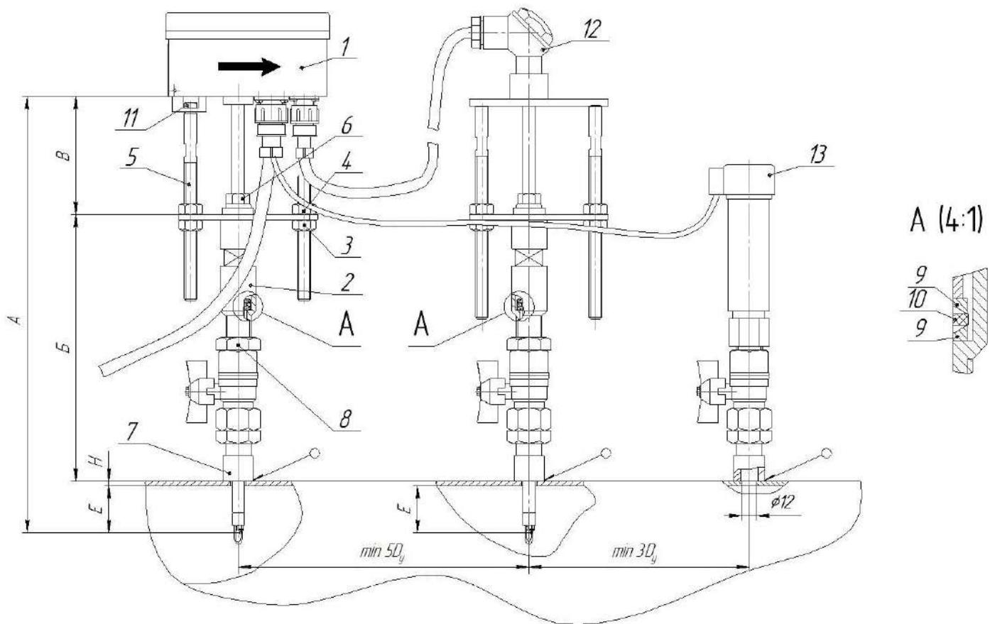
Рисунок Ж.6 – Монтаж выносного измерителя температуры
