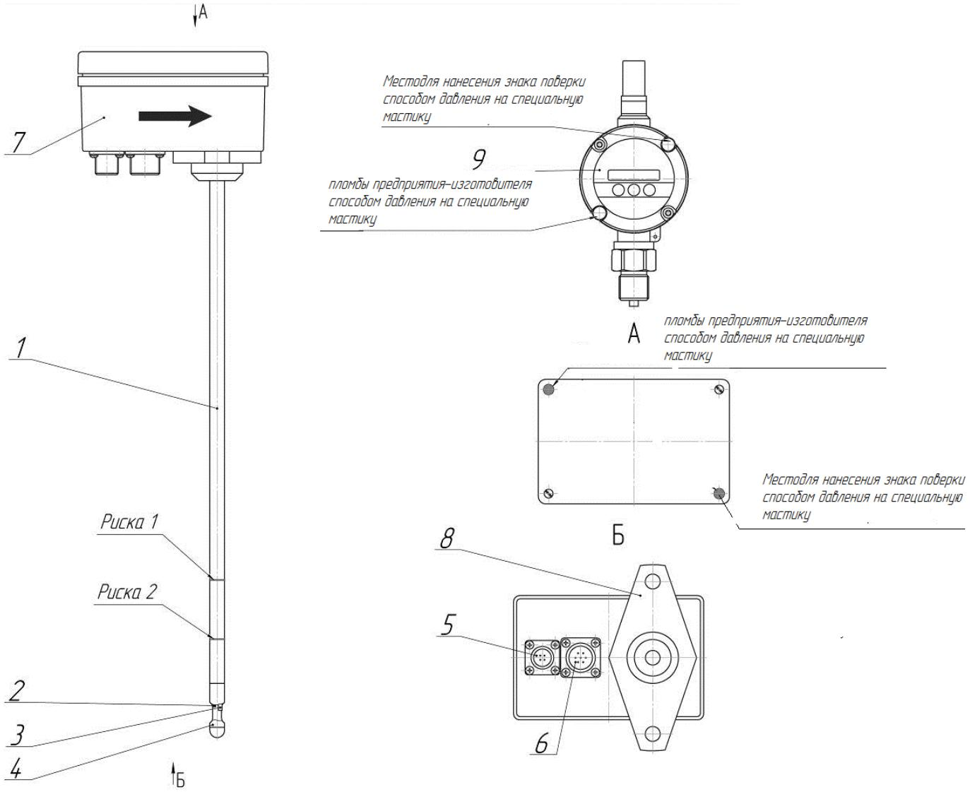
Рисунок Б.2 – Внешний вид блока ПП исполнения Ex ib выше 1,6 МПа
