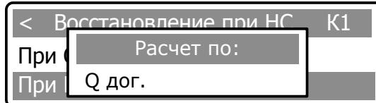
Повторным нажатием клавиши [ВВОД] активизируется режим выбора варианта подставляемого значения расхода при нештатной ситуации: Q дог. или Q ср.
