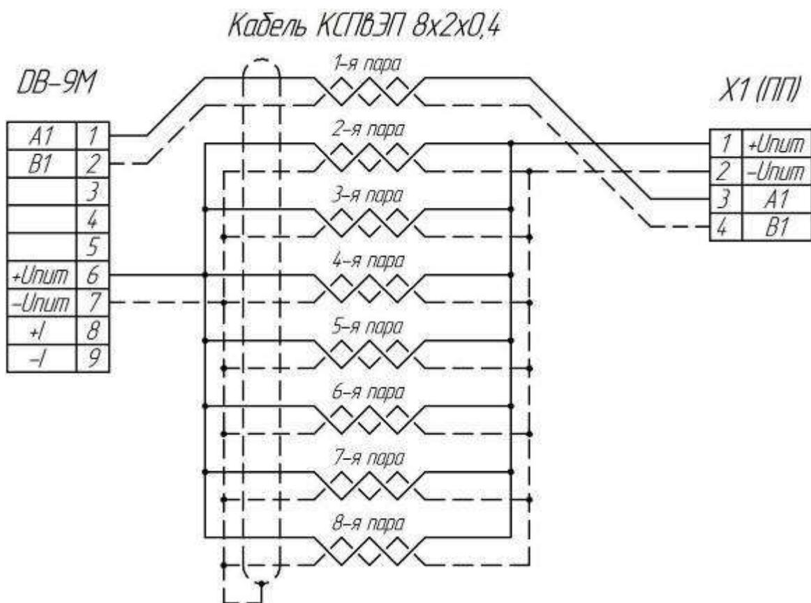
Рисунок М.11 – Схема кабеля при использовании КСПвЭП 8×2×0,4
