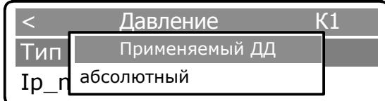
Повторным нажатием клавиши [ВВОД] активизируется режим выбора типа датчика:
