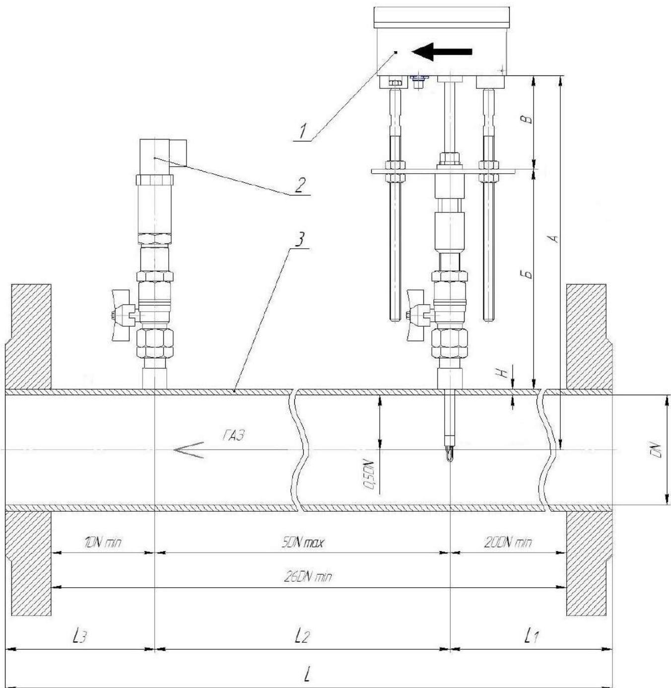
Рисунок Ж.1 – Монтаж ПП на трубопровод
