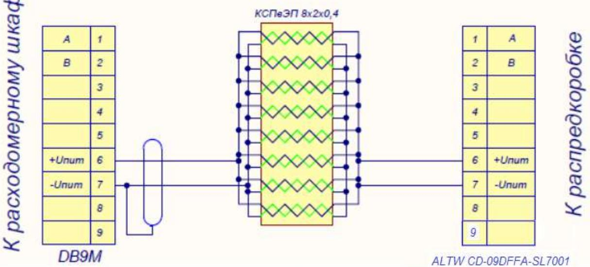
Рисунок М.9 – Схемы кабелей КСПвЭП 8x2x0,4 трехканального расходомера
