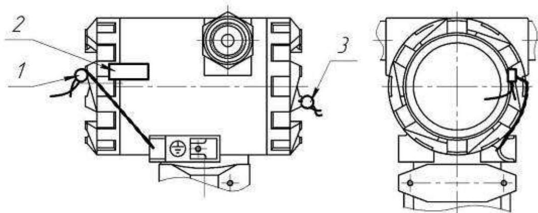
Рисунок Б.4 – Пломбирование блока ПП исполнения Ex db ib
