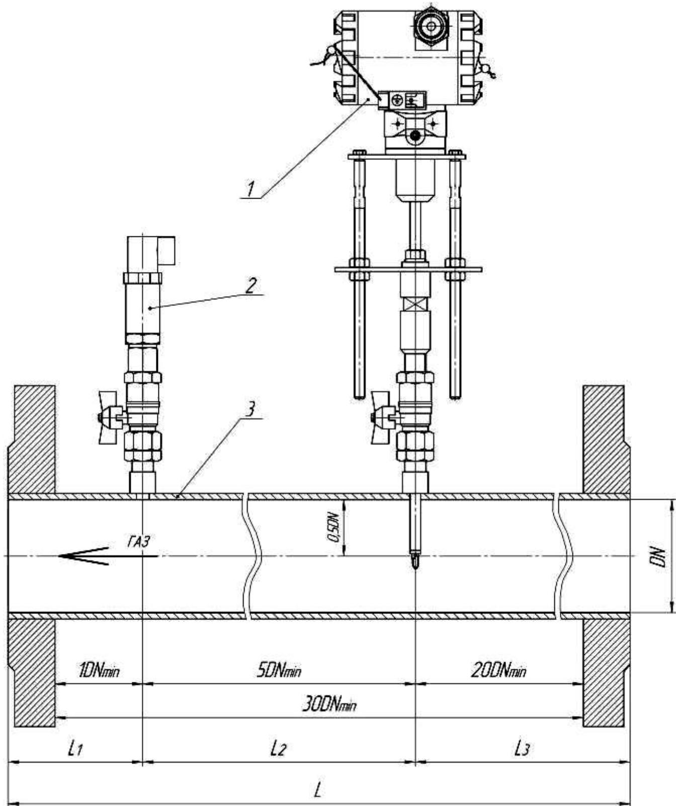
Рисунок Ж.2 – Монтаж ПП на трубопровод
