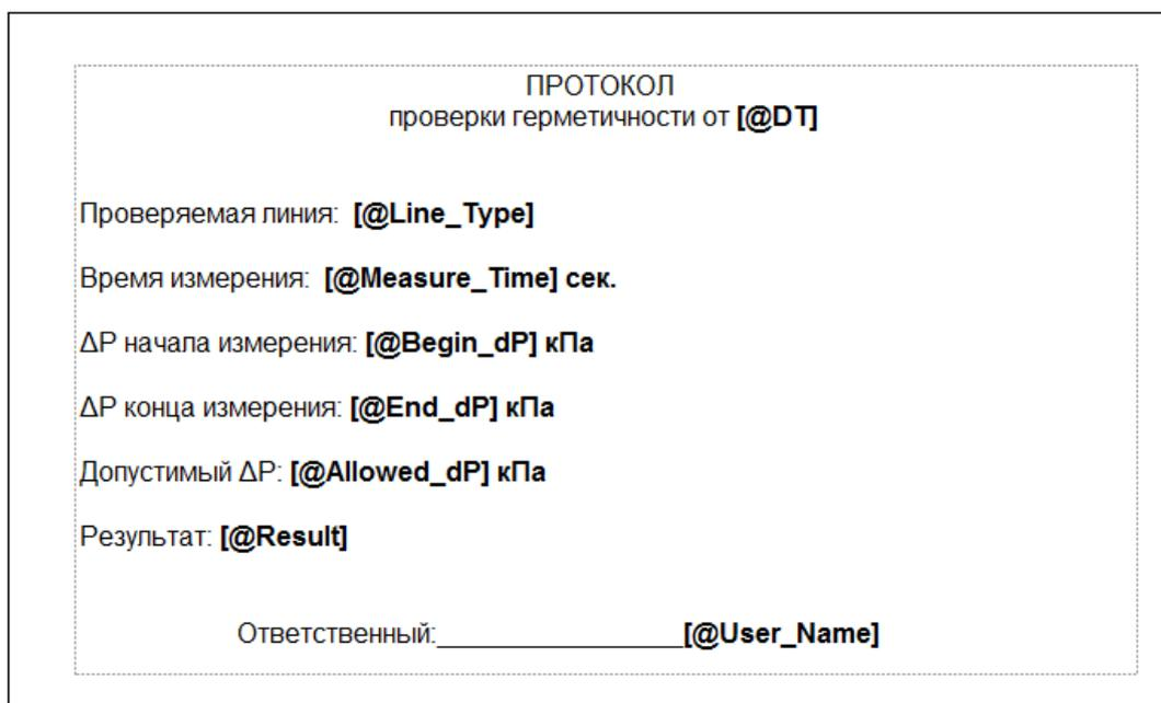
Рисунок 8 – Протокол проверки герметичности
